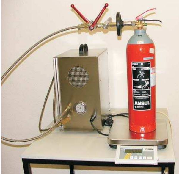
Das Bild zeigt den transportablen CO 2 -Verdichter mit einer Waage, welche nicht im Lieferumfang der Anlage enthalten ist.
